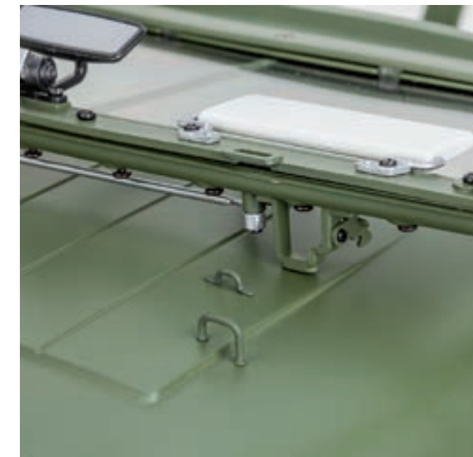
Шаг 15. Рамка ветрового окна может быть уложена поверх капота. При этом левый и правый упоры ветрового окна касаются поверхности капота, а элементы стеклоочистителей и детали зеркал заднего вида не соприкасаются с капотом.
