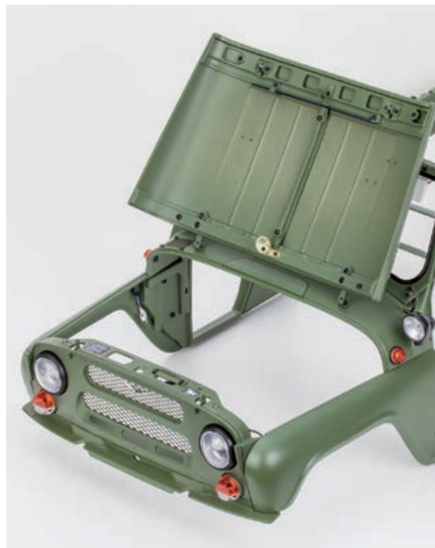
Шаг 14. Фиксация открытого капота возможна в двух положениях: посредством упора капота или крюком, расположенным на рамке ветрового окна (при полном открытии капота).
