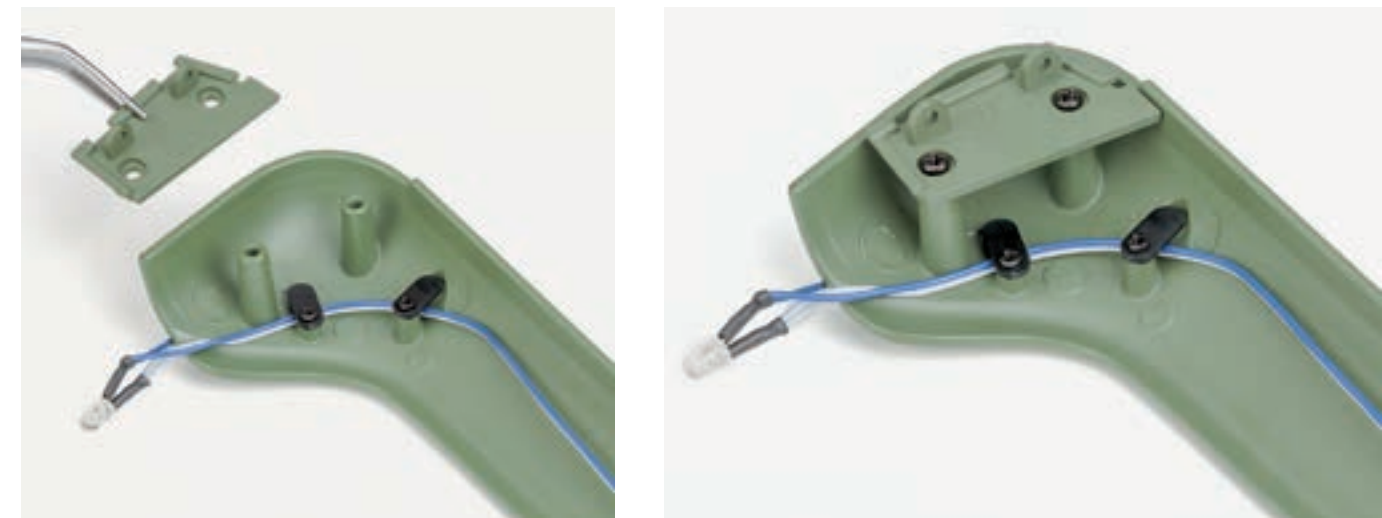
Шаг 3. В передней части правого крыла установите и закрепите двумя винтами 2,3×4 (PM) правую надставку облицовки радиатора.
