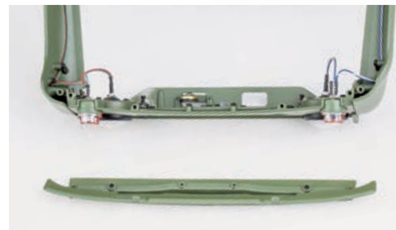
Шаг 8. Закрепите усилитель облицовки радиатора на нижней поверхности нижней панели облицовки радиатора. Для фиксации детали используйте два винта 1,7×5 (DM).
