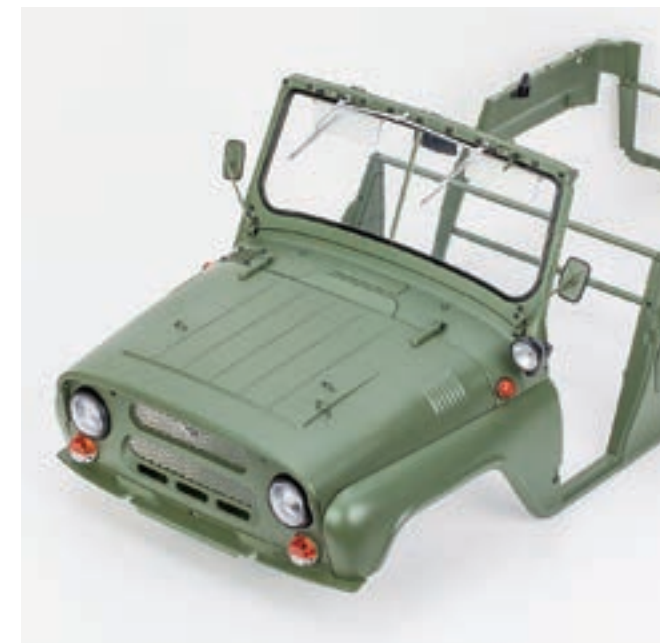
Шаг 15. Рамка ветрового окна может быть уложена поверх капота. При этом левый и правый упоры ветрового окна касаются поверхности капота, а элементы стеклоочистителей и детали зеркал заднего вида не соприкасаются с капотом.
