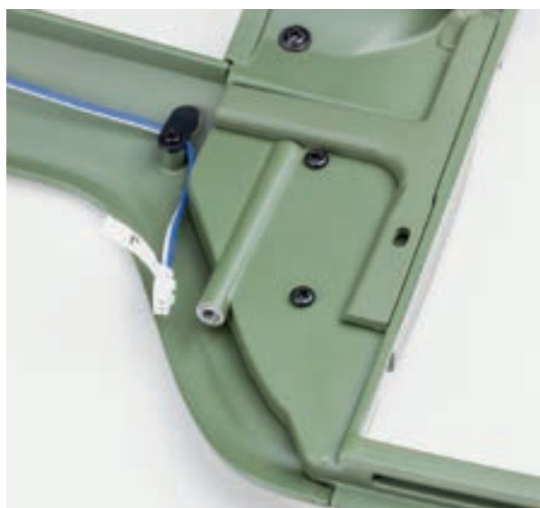
Шаг 5. Соедините правое переднее крыло с собранной ранее облицовкой радиатора и правой передней стойкой каркаса кузова. Закрепите правое крыло с внутренней стороны каркаса двумя винтами 2,3×5 (IM). Провод от передних светодиодов не должен быть зажат между крылом и каркасом.
