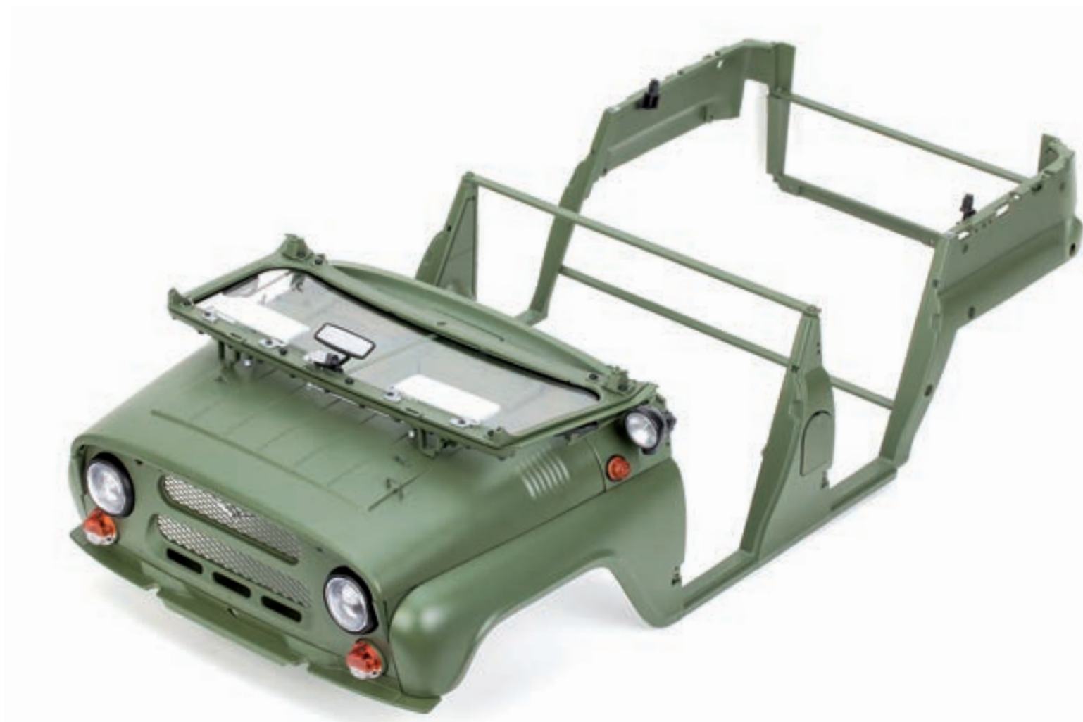
Шаг 15. Рамка ветрового окна может быть уложена поверх капота. При этом левый и правый упоры ветрового окна касаются поверхности капота, а элементы стеклоочистителей и детали зеркал заднего вида не соприкасаются с капотом.
