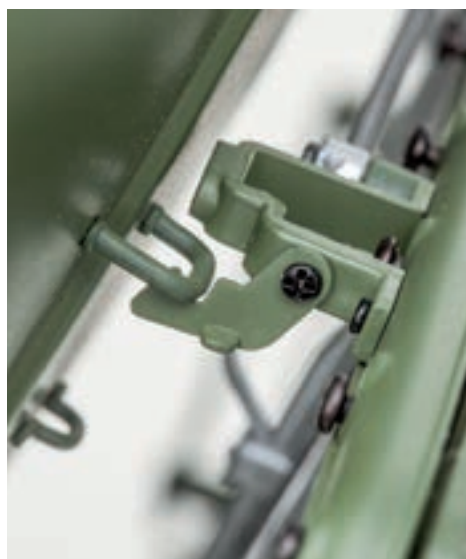
Шаг 14. Фиксация открытого капота возможна в двух положениях: посредством упора капота или крюком, расположенным на рамке ветрового окна (при полном открытии капота).
