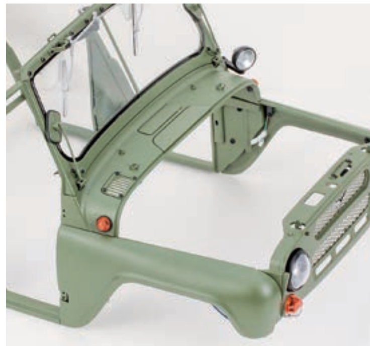
Шаг 5. Соедините правое переднее крыло с собранной ранее облицовкой радиатора и правой передней стойкой каркаса кузова. Закрепите правое крыло с внутренней стороны каркаса двумя винтами 2,3×5 (IM). Провод от передних светодиодов не должен быть зажат между крылом и каркасом.
